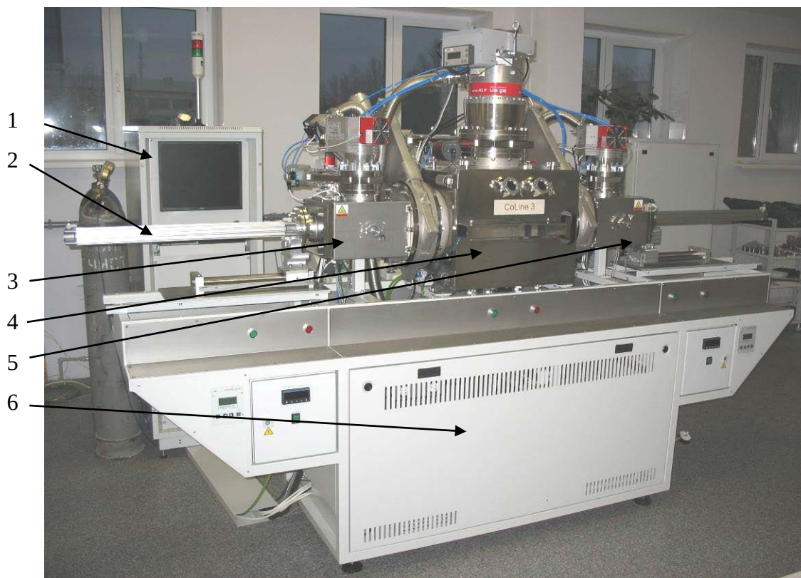
Рис.4 Вакуумный откачной пост установки, где 1 – стойка управления; 2 – манипулятор; 3 – камера загрузки; 4 – технологическая камера; 5 – камера выгрузки; 6 – станина с блоками питания и системой газоподдачи.
