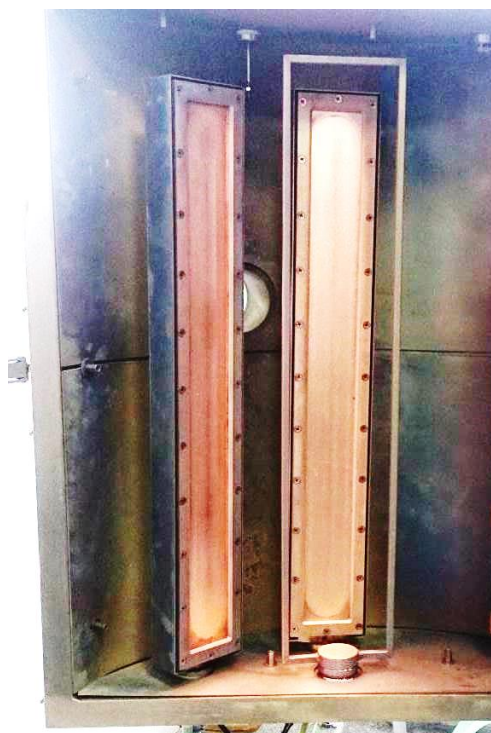
Фото 5 Внешний вид дуальной магнетронной распылительной системы.
